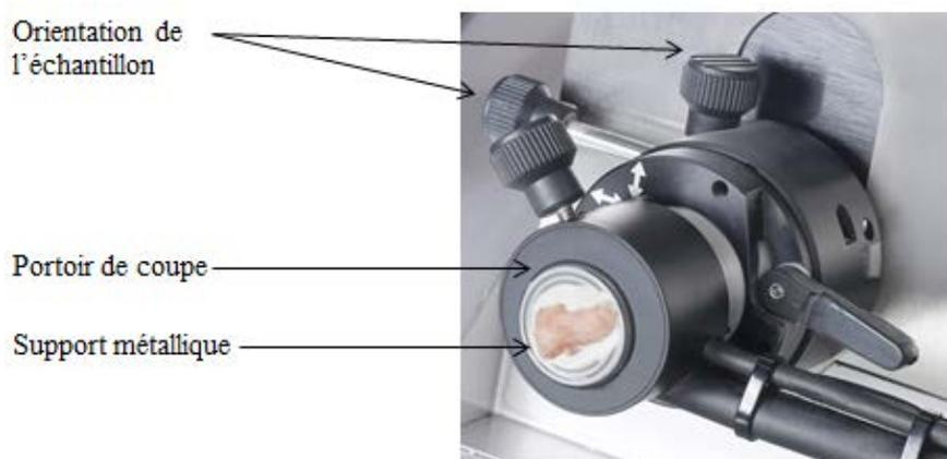
Figure 9 : Porte échantillon du cryostat.
