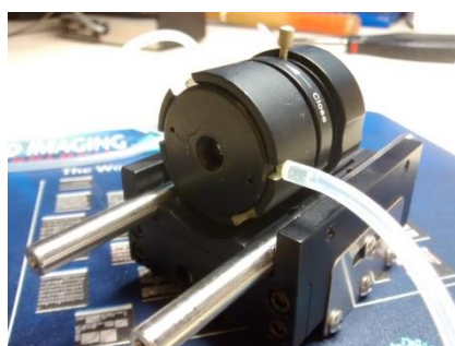
Figure 6 : Support de cuve avec cuve
