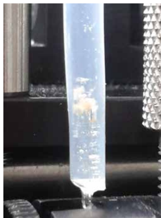
Figure 14 : colmatage de la cellule de flux 100 \mu m.
