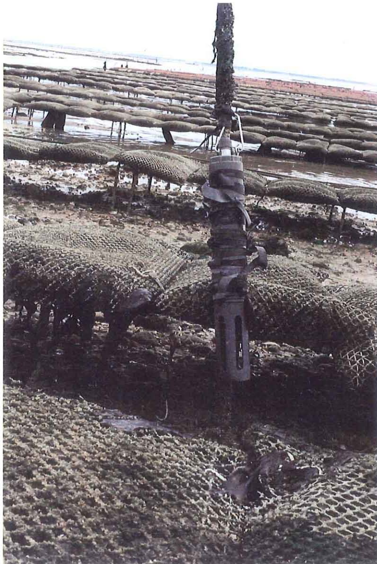
Photo 6 : Sonde YSI permettant la mesure des paramètres environnementaux du site de Fouras.
