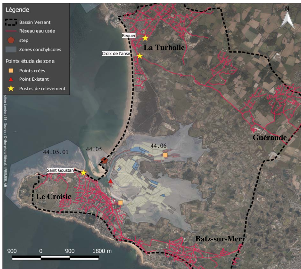
Figure 8 : Réseau d'eaux usées de la zone étudiée
