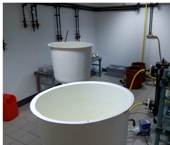
Figure 5 : Dispositif expérimental de désinfection par rayonnement UV basse pression
