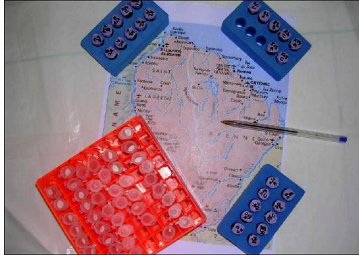
Figure 32: Exemple de volume d'échantillons correspondant à 10 stations DGT (en triplicat) et SBSE (en triplicat) prêts pour l'analyse après conditionnement sur place (campagne de 2010 en Guyane). Les méthodologies "classiques" auraient nécessité, pour le dosage des mêmes contaminants, le prélèvement d'un peu moins de 100 L d'eau.
