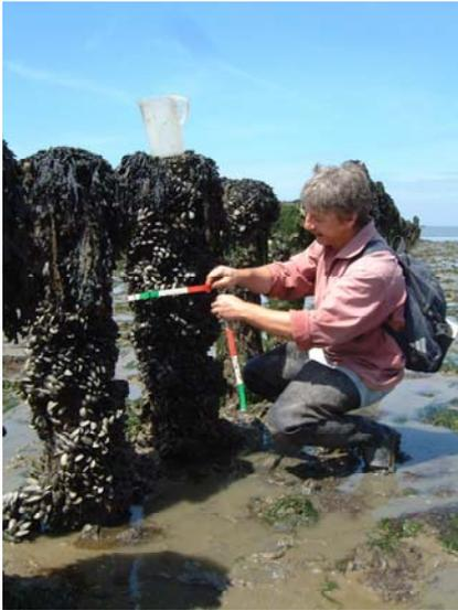
Figure 31. Mesure de la section totale d'un pieu
