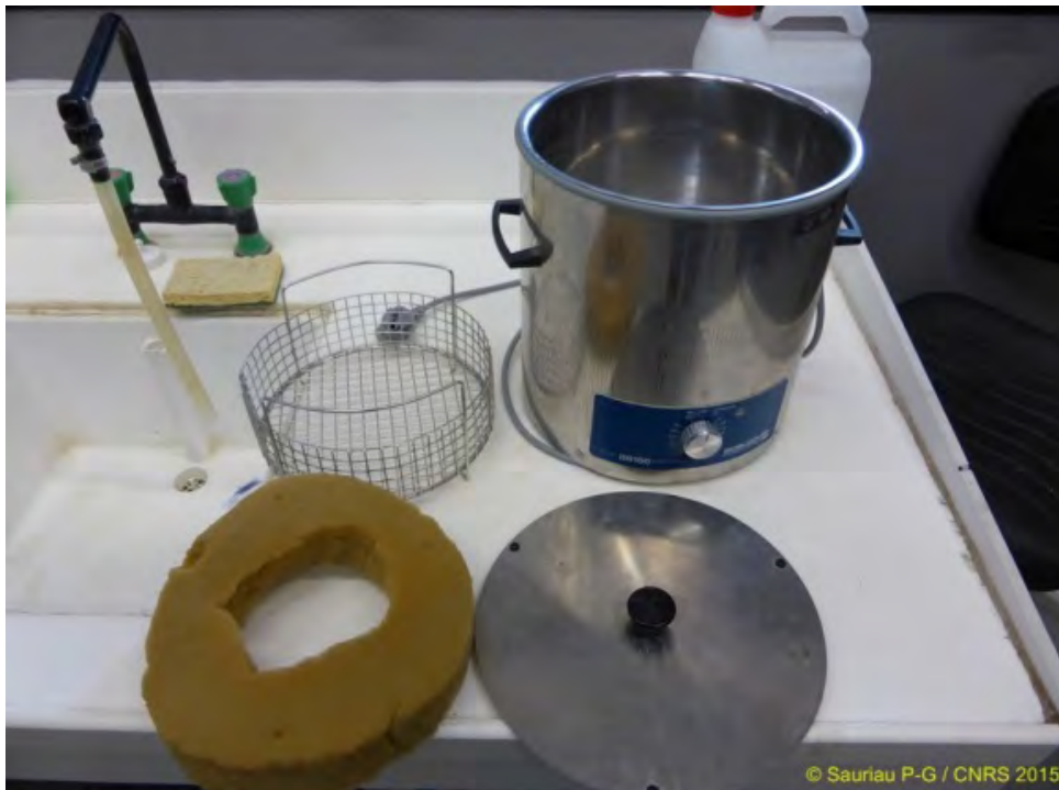
Figure 22 : Bain à ultrasons (A) avec détails du porte tamis et de la collerette en mousse (B) pour maintenir un bol à sédiment. Photo P.-G. Sauriau CNRS ©.
