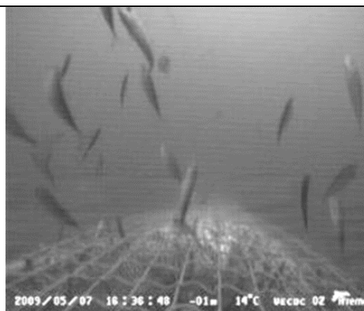
Echappement de maquereaux au travers du PMC dorsal
