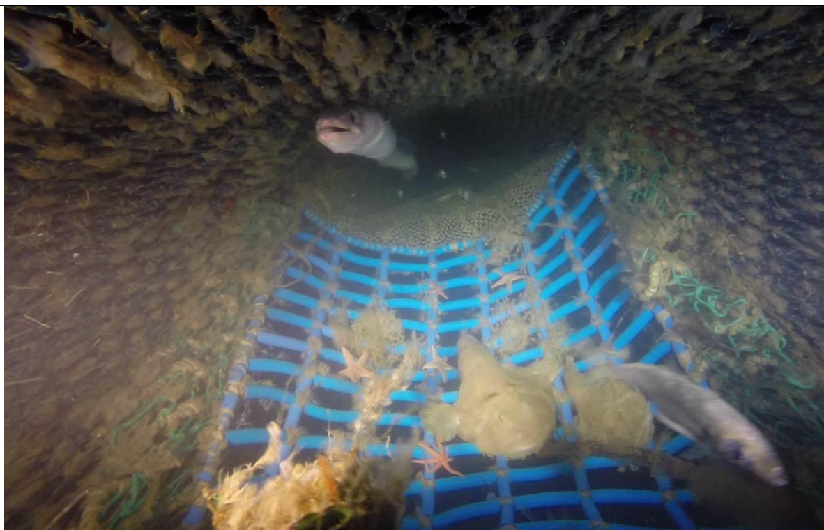
Photo 14 : grille souple (V4) sur le Men Brial. Congres au-dessus de la grille et lottes sur la grille.
