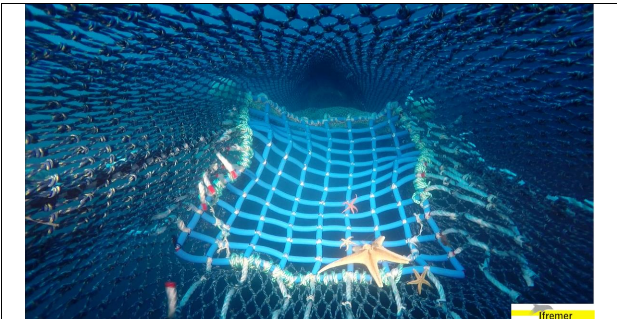
Grille souple (V3) au virage sur le Men ar Groas Vue de face - Image GoPro
