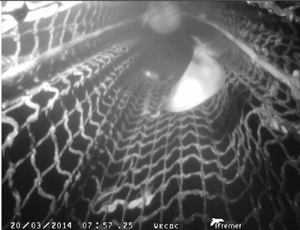
Cylindre à mailles carrées avec boule dispersive Image VECOC
