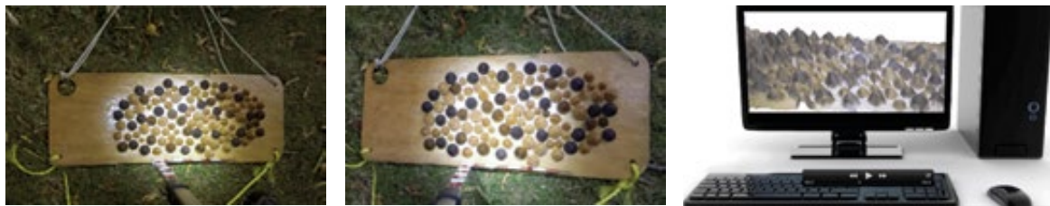
Figure 25. Reconstitution 3 D à partir de 2 images dans le cas de la plaque « biocolmar » avec couleurs variées et sans turbidité (Université de Nantes – GeM-MMS-IXEAD-Biolittoral/MAREI (Irlande))
