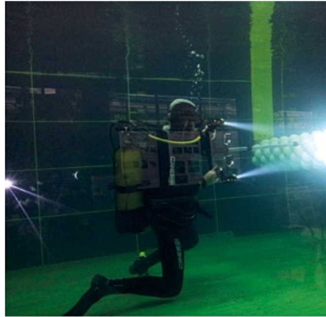
Figure 24. Essais en bassin Ifremer (Boulogne) – Financés par la société TOTAL pour la validation du protocole développé dans COSELMAR dans le cas d'une rugosité mono-couleur et absence de turbidité.
