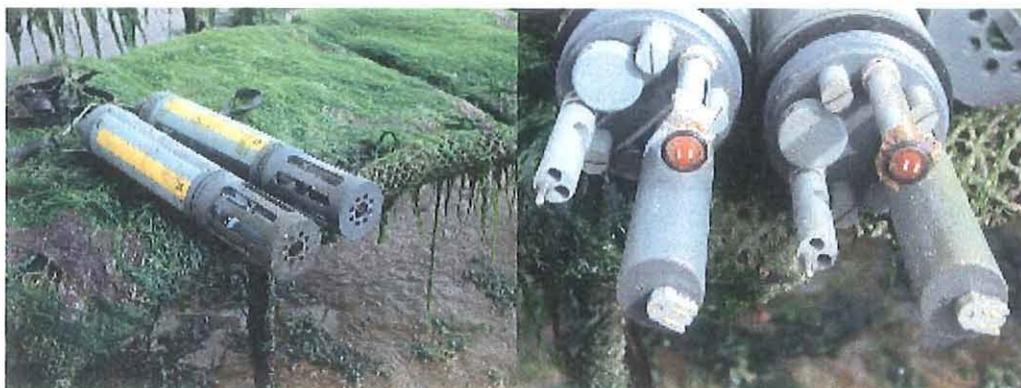
Figure 8 : Photographie de deux sondes multiparamétriques ISY avec et sans la grille de protection.
