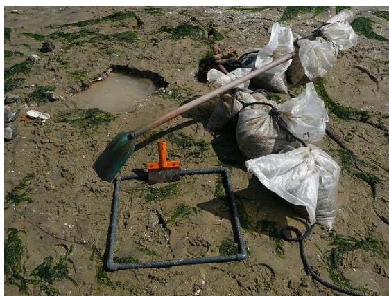
Photo 5 : Matériel de prélèvement - cadrat, pelle, grattoir, sacs, mouillage - et empreinte d'une zone prélevée. (Source : S. Robert)
