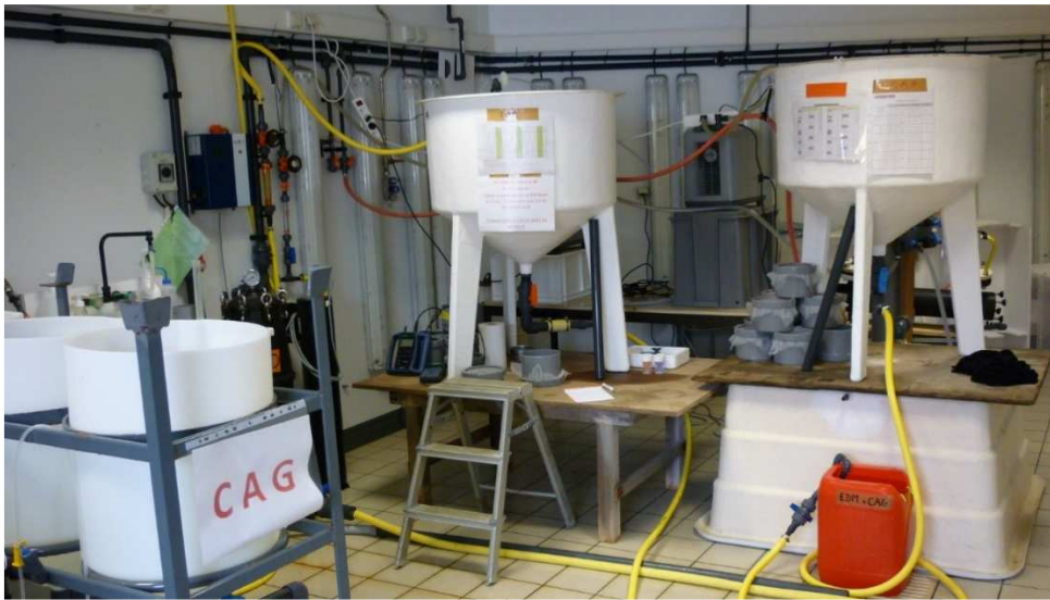
Figure 38 : Aménagement retenu pour l'alimentation des bacs (à gauche) grâce à deux bacs cylindro-coniques de 250 litres
