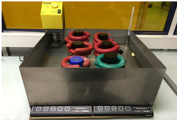
Figure 15 Photographie du dispositif expérimental d'adsorption en réacteur batch
