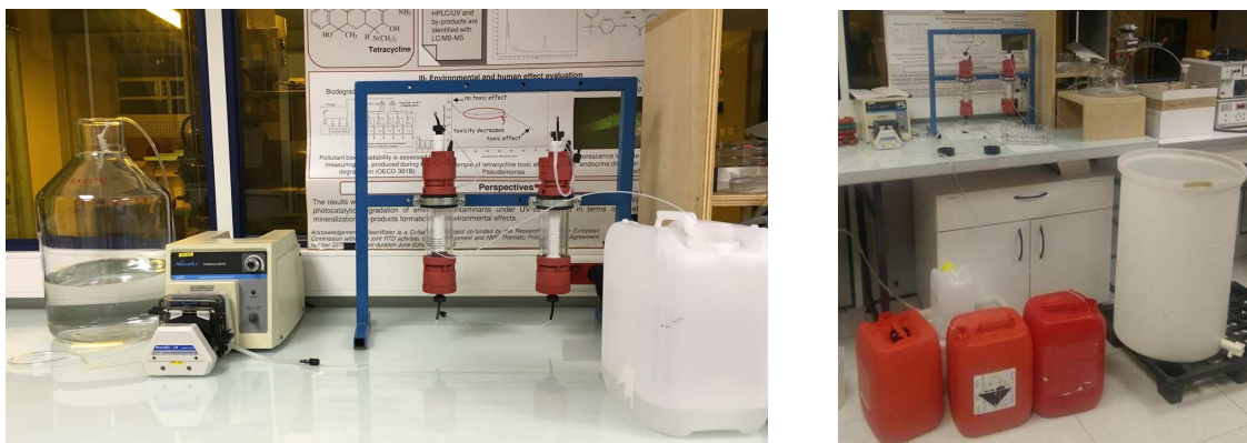
Figure 22 Photographie du dispositif expérimental des essais sur colonnes remplies
