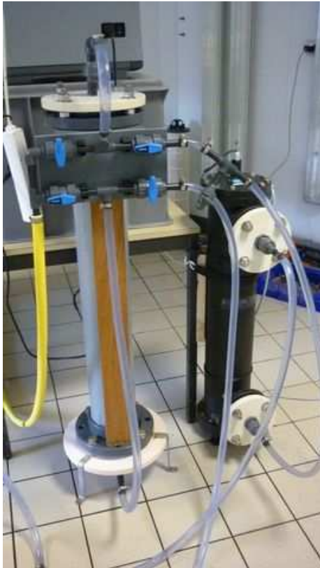
Figure 35 : Colonne d'adsorption IFREMER et réacteur UV en aval
