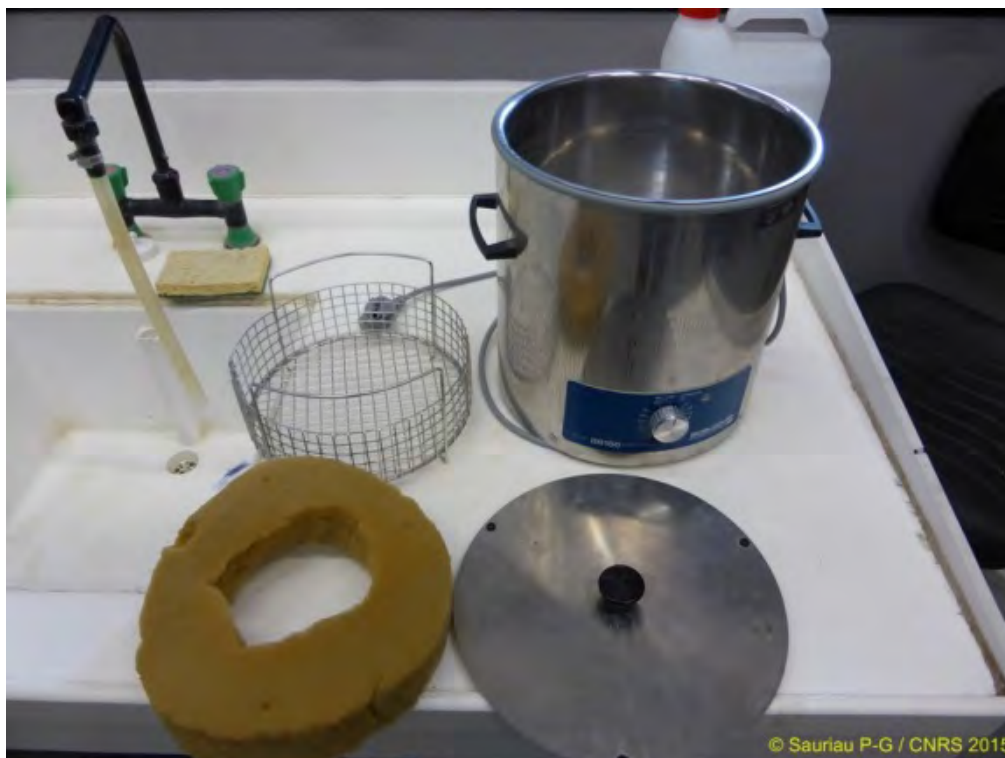
Figure 12 : Bain à ultrasons (A) avec détails du porte tamis et de la collerette en mousse (B) pour maintenir un bol à sédiment. Photo P.-G. Sauriau CNRS ©
