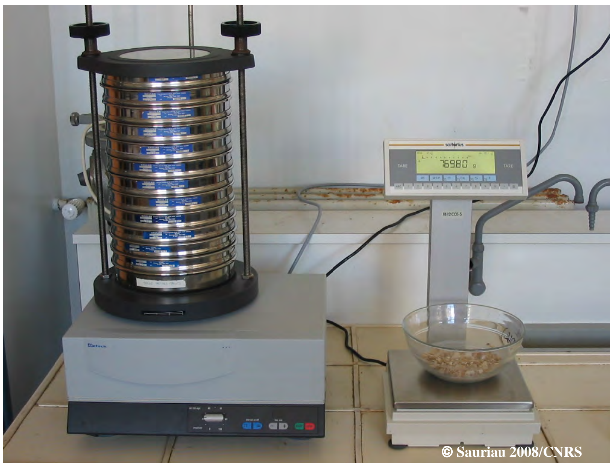
Figure 11 : Colonne de tamis normalisés AFNOR sur tamiseuse Retsch et balance Sartorius à 0,01 g. Photo P.-G. Sauriau CNRS ©.
