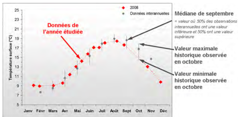
Figure 3 : Interprétation des graphiques de présentation des paramètres physico-chimiques et hydrologiques.
