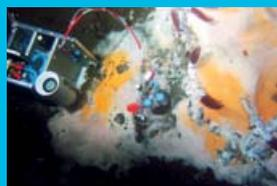
Déploiement de modules de colonisation sur les tapis microbiens. La température dans le sédiment peut atteindre 120°C à une vingtaine de cm de profondeur
