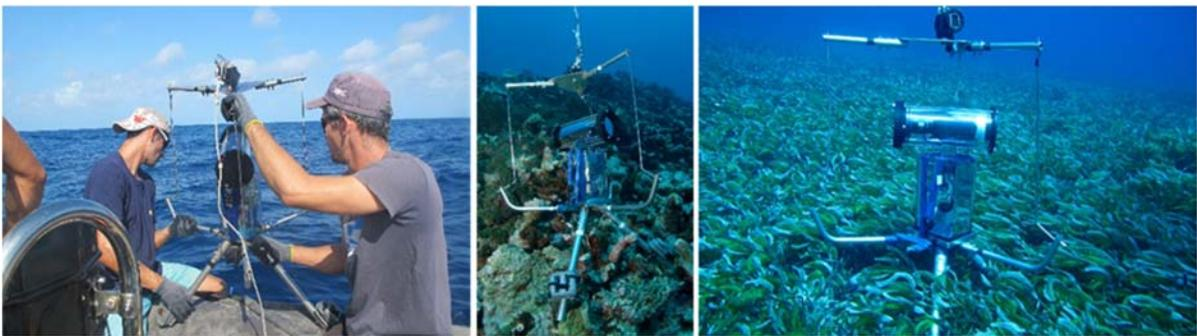
Figure 54 : Illustrations de la mise à l'eau et de positionnements du système STAVIRO (SVR – station vidéo rotative) sur un habitat corallien et un herbier.
