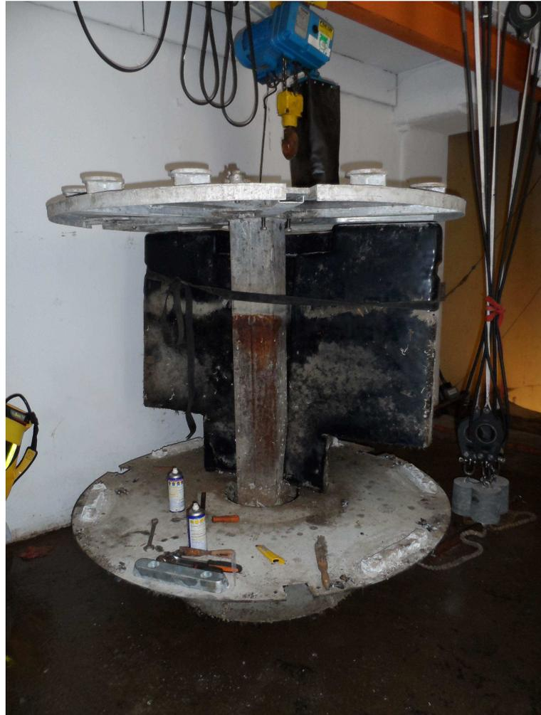
Figure 7. Opération de maintenance sur le flotteur (support des capteurs, du module de gestion et de transmission des données).
