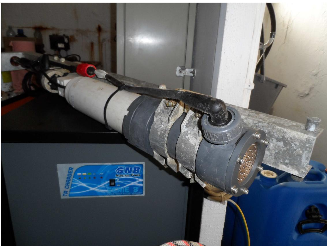
Figure 10. Remplacement de la sonde multiparamètre NKE MP6 et vérification de l'efficacité du système de chloration.
