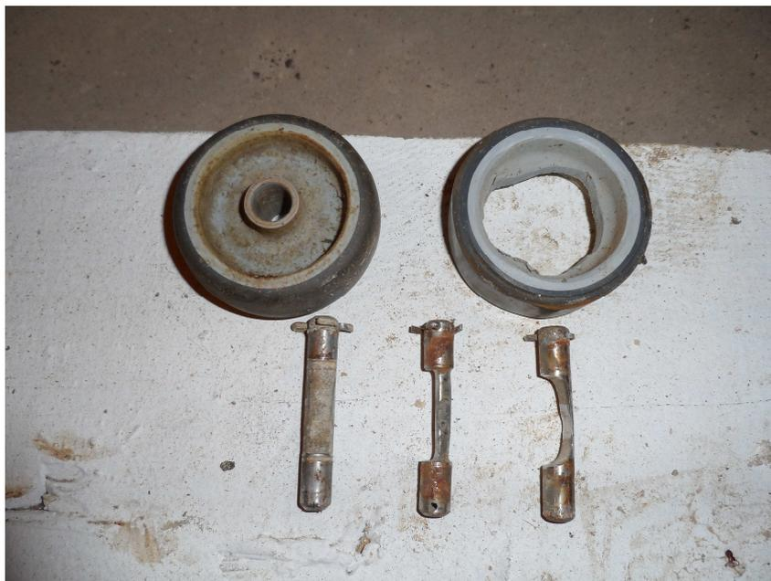
Figure 9. A Gauche : Galet de guidage du flotteur et son axe après quelques jours d'utilisation. A Droite : Les mêmes éléments après quelques semaines de déploiement.
