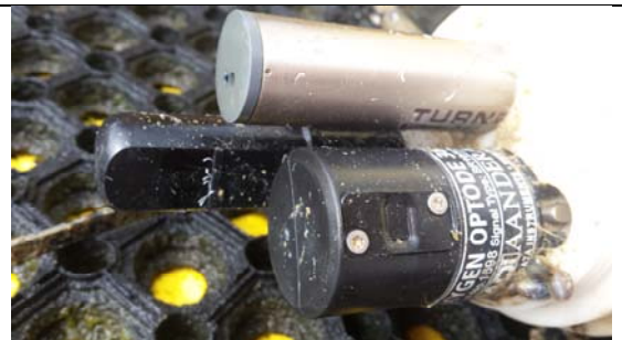
Figure 17. Biofouling observé sur les capteurs le 3 juillet 2017
