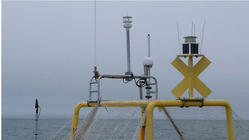
Figure 3. Station météorologique et pyranomètre installés sur la bouée MOLIT
