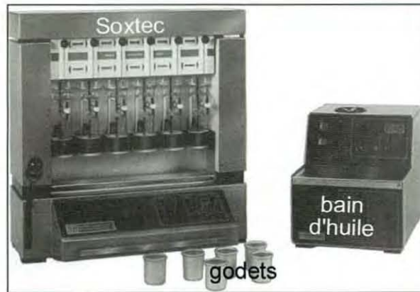
Figure 6 : Soxtec utilisé pour l'extraction des composés hydrophobes dans les lyophilisats de foies.
