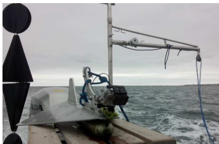
Figure 7 : Caméra vidéo fixée sur le dépresseur profilé
