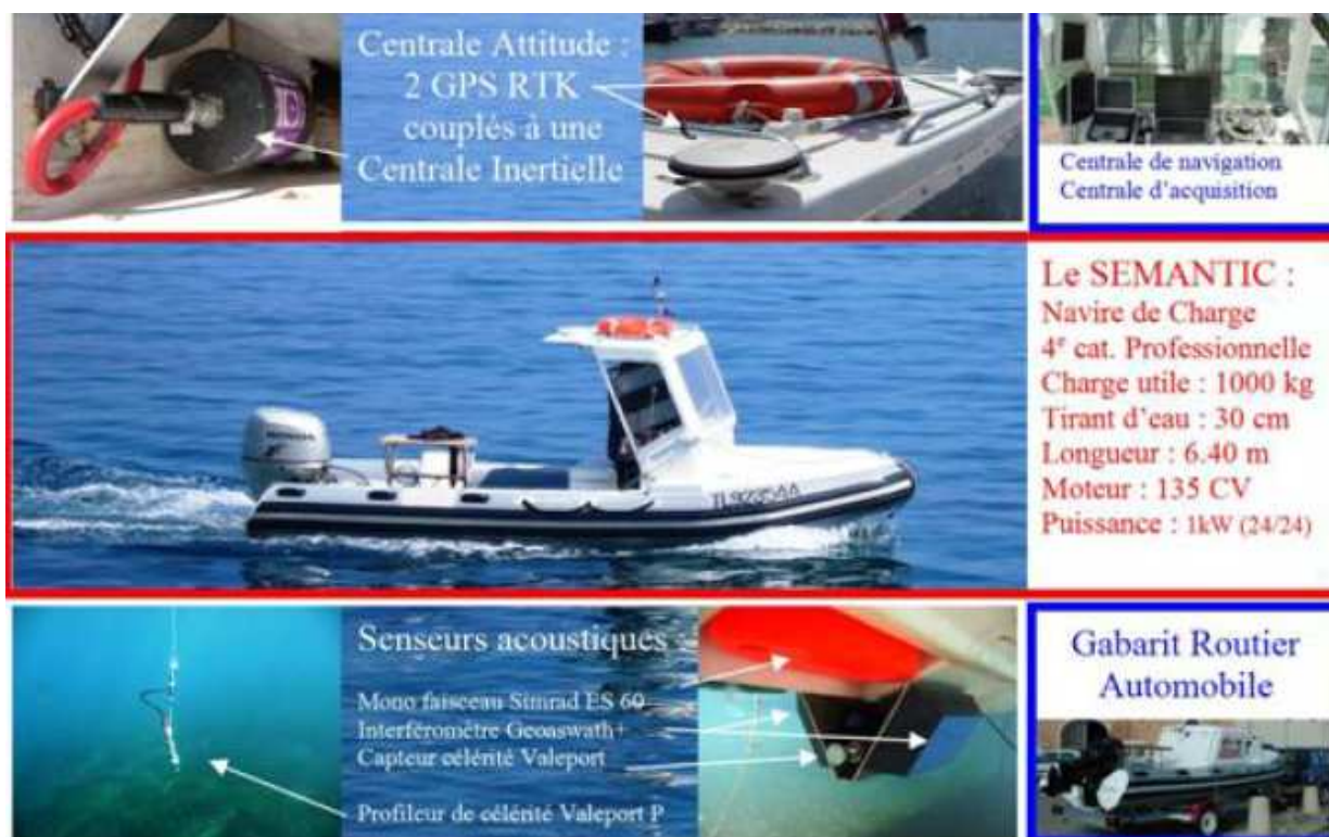
Figure 3 : Méthode d'acquisition multi-capteurs opérée dans le bassin d'Arcachon en 2008 et 2016
