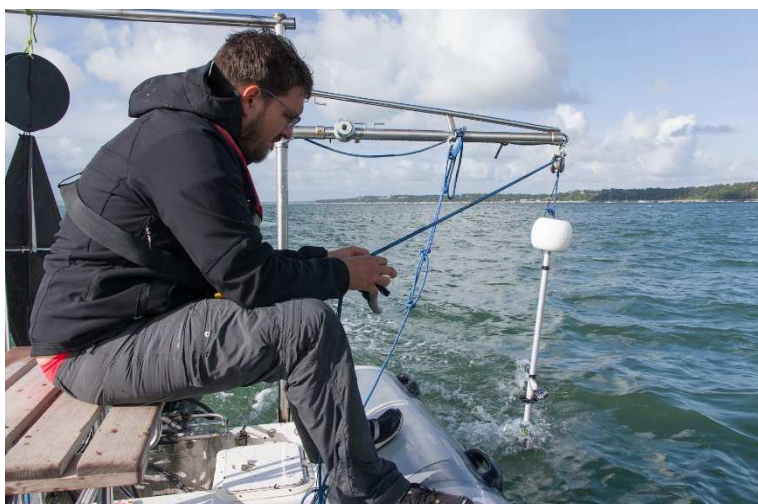
Figure 8 : Caméra fixée sur une perche, technique par sondage
