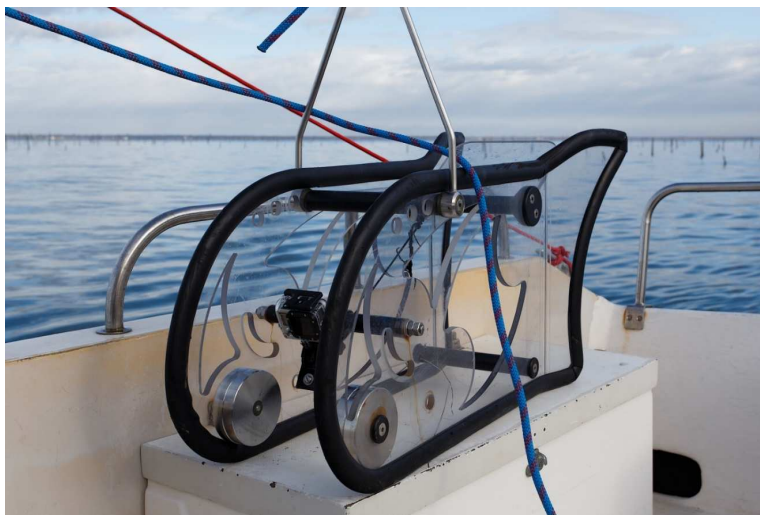
Figure 9 : Caméra Gopro fixée sur le poisson remorqué « Moogli »
