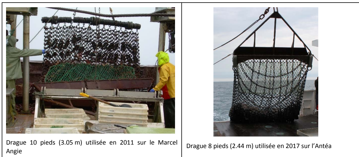
Figure 4 : Engin de prélèvement utilisé : drague de type « New Bedford ».
