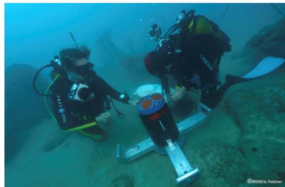
Fig. 4.b : Pose d'un courantomètre (Crédit Photo : Eric Folcher - IRD)
