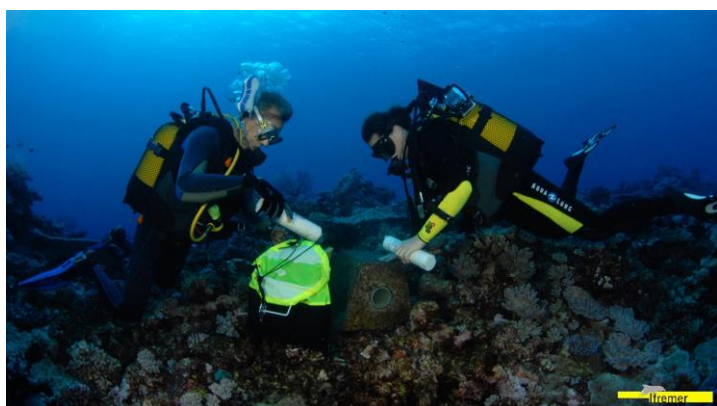
Fig. 2.b : Relève/repose d'un capteur RBR
