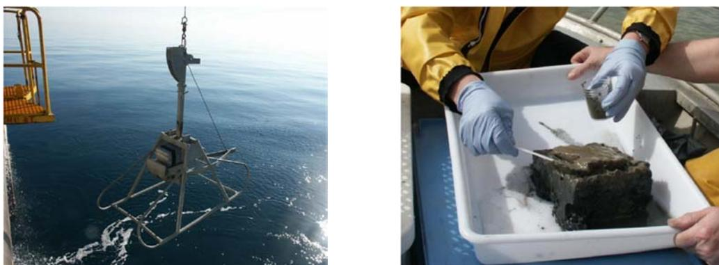
**Figure 2** : Carottier-boîte « petit Reineck » (à gauche), et prélèvement du centimètre supérieur du sédiment (à droite).
