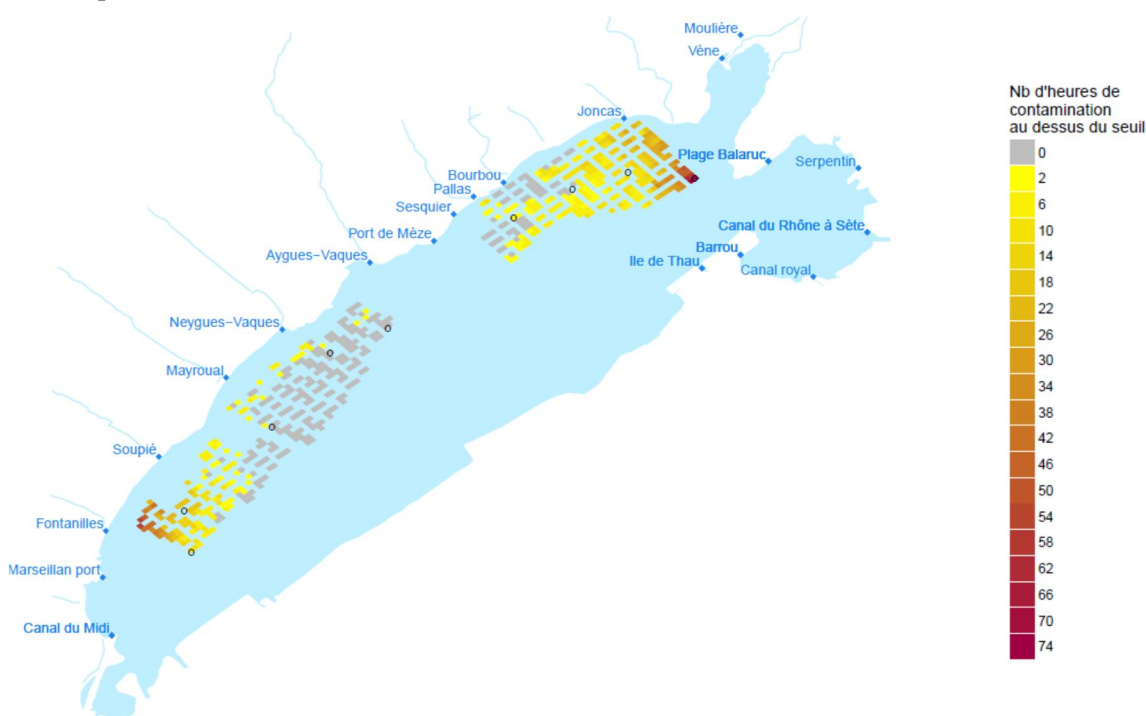
Figure 21 : Nombre d'heures de contamination au-dessus de 920 E.coli /100ml d'eau au cours des simulations des événements pluvieux de 2008 à 2015
