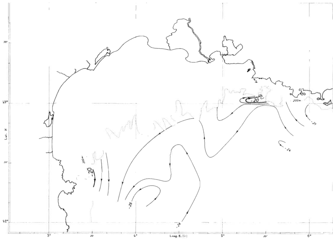
FIG. 7. — Golfe du Lion. Topographie dynamique (en cm dyn.) et sens des courants, au niveau de 200 décibars par rapport au niveau de référence de 500 décibars.
