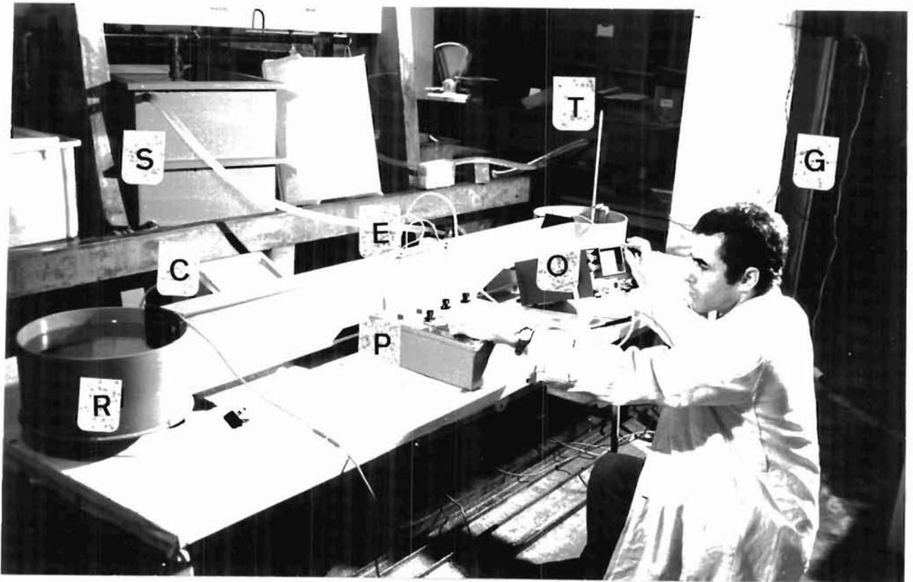
Fig.8: Photographie montrant l'ensemble du montage expérimental utilisé pour mesurer les seuils de taxie et de tétanie des poissons.
