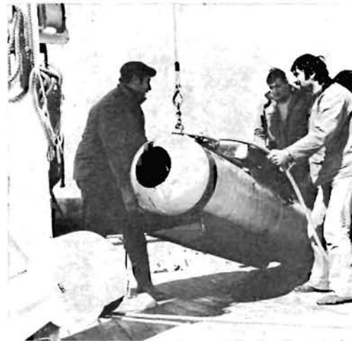
FIG. 1. — Schéma du Gulf III « encased » (à gauche) ; vue de ce même collecteur (à droite) ; photo I.S.T.P.M.
