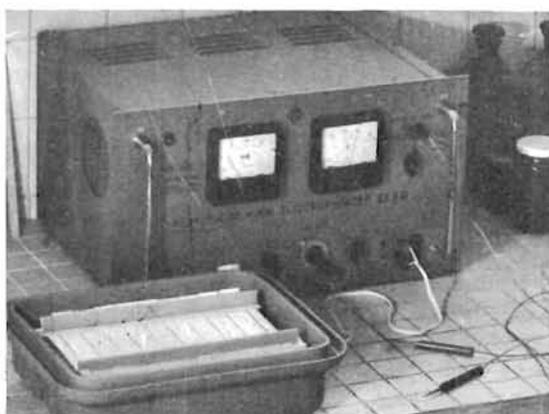
FIG. 19. — Installation utilisée pour l'électrophorèse.
