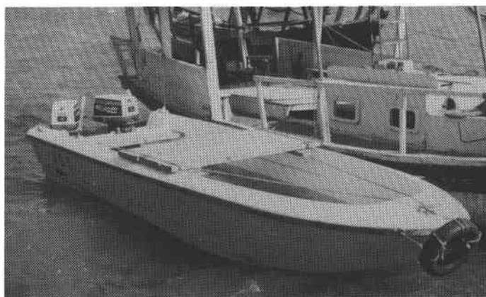
Fig. 3. — Notre barge, équipée de deux moteurs de 40 cv: ainsi propulsée, elle pouvait effectuer le trajet de Djibouti aux îles en moins de 25 mn (à vide); la plateforme en bois a servi au transport des blocs de 150 kg.
