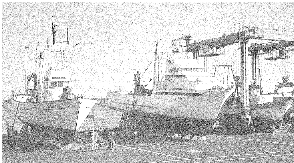
FIG. 1. — A gauche, thonier senneur coque bois, 25 m, 430 ch, construit en 1973; à droite, thonier senneur méditerranéen de la nouvelle génération, type Assidepa Languedoc-Roussillon (27 m, 600 ch, coque plastique) construit en 1979.
