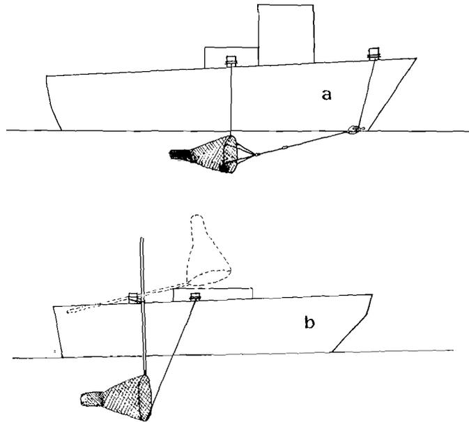
FIG. 1. — Position et arrimage du grand tamis circulaire en action de pêche :
