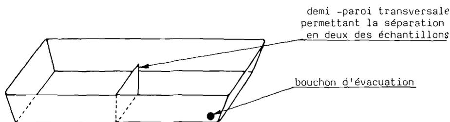
FIG. 3. — Cuve à bipartition type Motoda.
