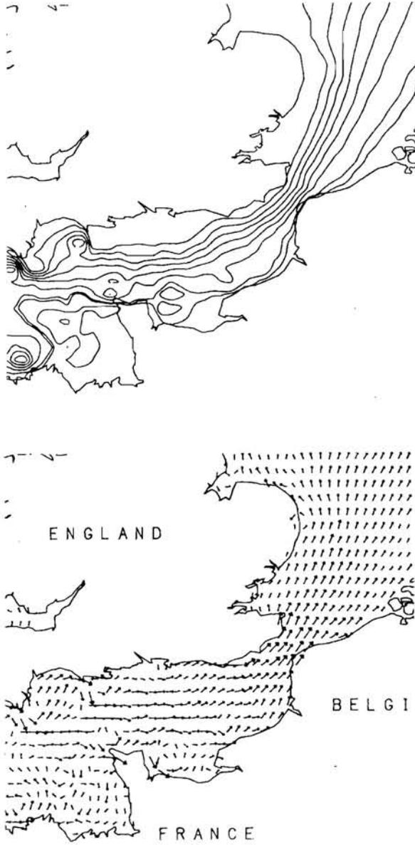
Fig. 9. : Circulation résiduelle avec TRME et avec vent d'été
