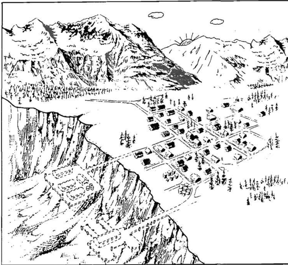
Figure 3 : Reconstitution du paysage littoral de la ville de Valdez (Alaska) après le tremblement de terre de 1964. les installations représentées en pointillé ont été emportées en mer par le glissement engendré par le séisme. D'après Coulter et Migliaccio, U.S. Geological Survey, 1969.
