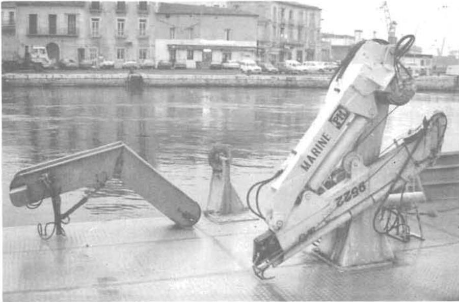
Figure 142 - Tapis roulant pour relever les suspensions (à gauche sur la photo). Quand ils s'en servent, les exploitants le placent à angle droit du bateau, la partie basse plongeant dans l'eau.
