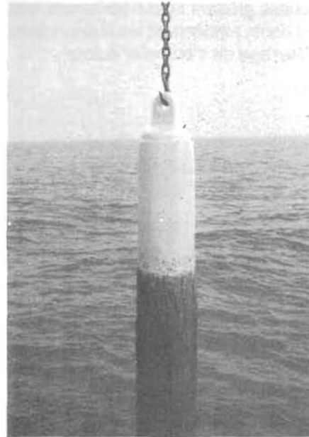
Figure 136 - Accéder à la filière en soulevant les flotteurs : pratique mais attention à la résistance des bouts d'amarrage
