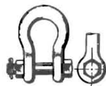
Figure 59 - Axe boulon : l'usure est à surveiller de près
