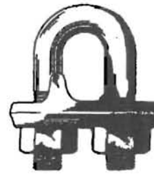
Figure 78 - Serre-câbles à étriers : ils abîment l'aussière
