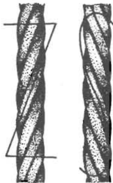
Figure 63 - Manières de disposer les torons sur l'âme centrale : à gauche, en Z ; à droite, en S.
