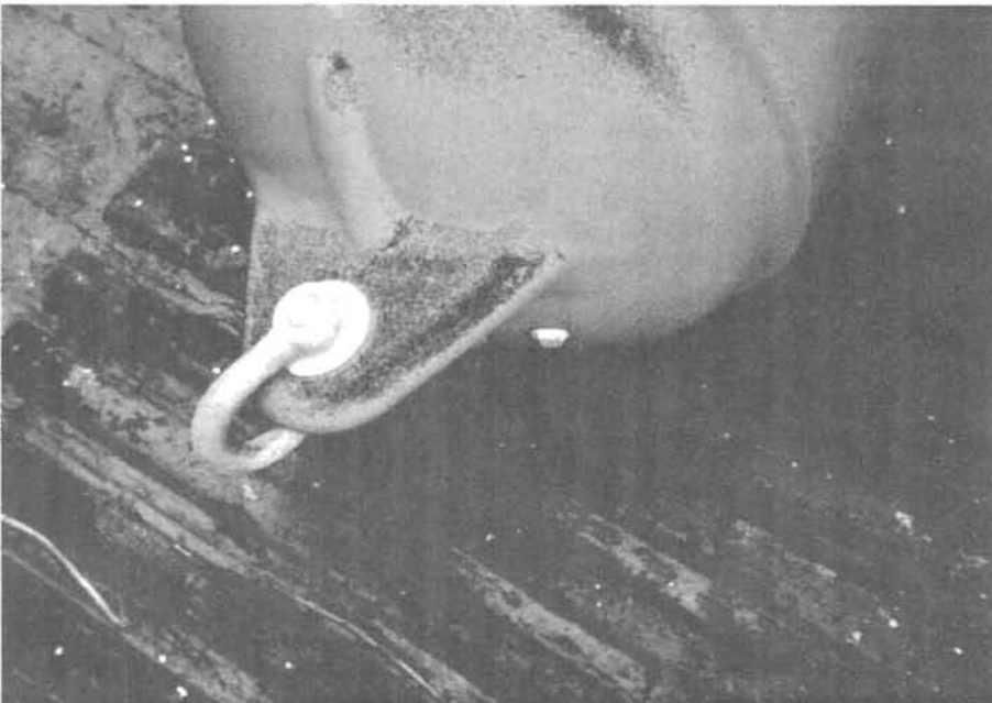
Figure 85 - Pièce de plastique placée dans l'anse du flotteur (en plus clair sur la photo) Elle protège le flotteur contre le frottement incessant de la manille
