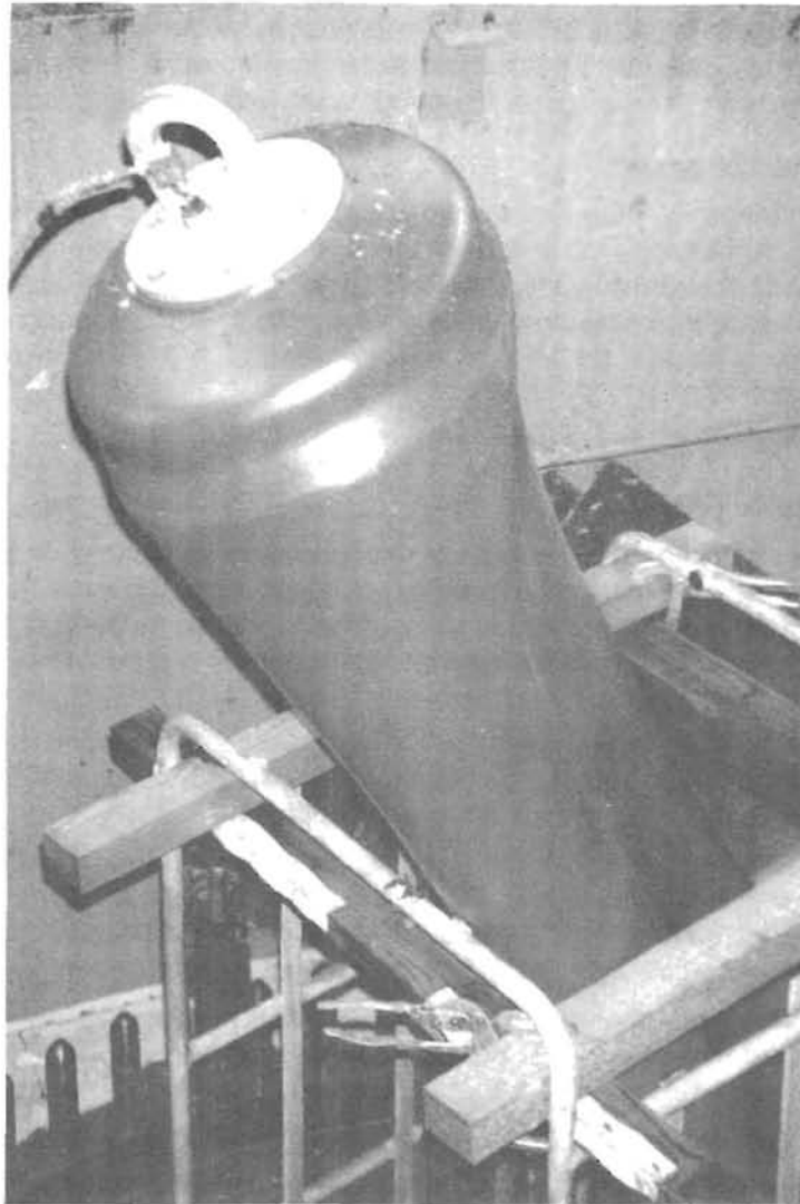
Figure 65 - Ce flotteur s'est aplati sous l'effet de la pression externe
