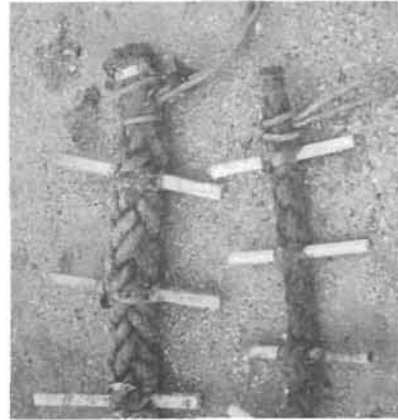
Figure 71 - Suspensions de 40 et 100 mm de diamètre munies de taquets
