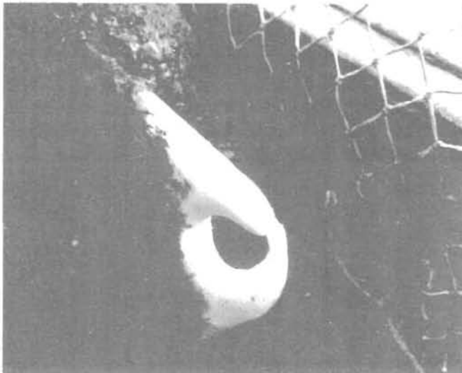
Figure 82 - L'anse de ce flotteur s'est usée puis déchirée à cause du frottement de la manille sur le plastique
