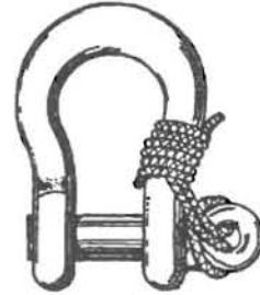
Figure 94 - Freiner une manille à l'aide d'un petit bout nylon : bonne solution mais attention au ragage du bout
