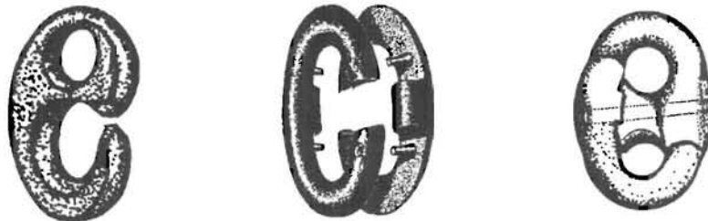
Figure 61 - Maille dieppoise, maille brisée, maille Kenter : souvent moins adaptées que les simples manilles
