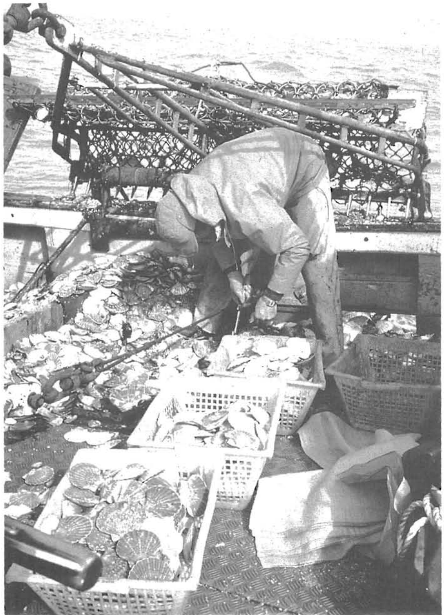
La pêche de la coquille Saint-Jacques s'effectue à l'aide d'une drague de deux mètres d'ouverture avec un sac en mailles métalliques de 72 mm de diamètre (photo Barbaroux-Ifremer).
