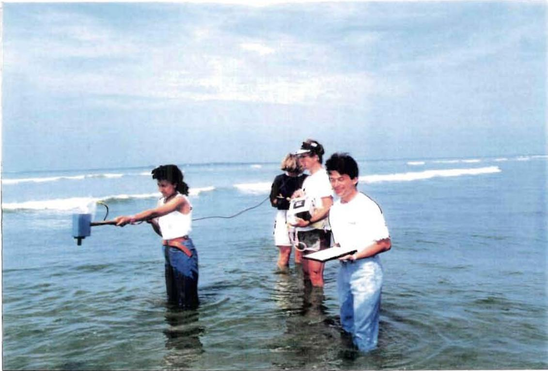
*Fig. 16 : Mesure de la réflectance des ulves immergées.*
