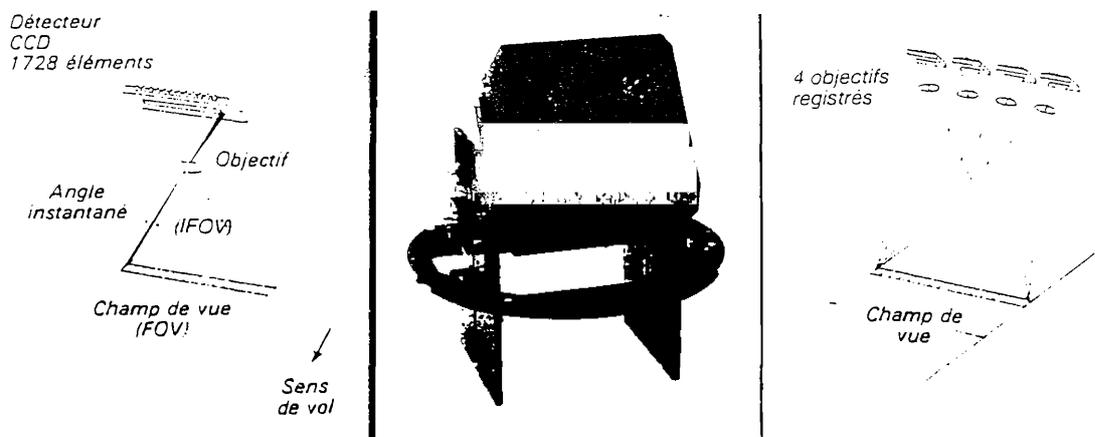
Fig. 18 : Le radiomètre à balayage RAMI .
