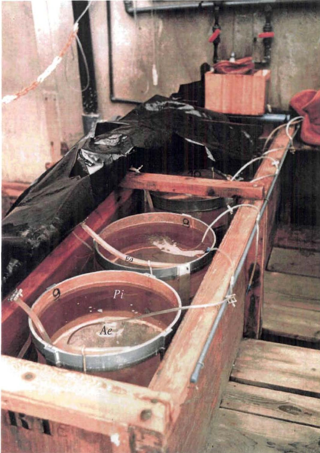
Figure 2. Unité d'incubation. Pi : panier d'incubation en toile à plancton; Ae : aération centrale; Ea : entrée d'eau de surface.
