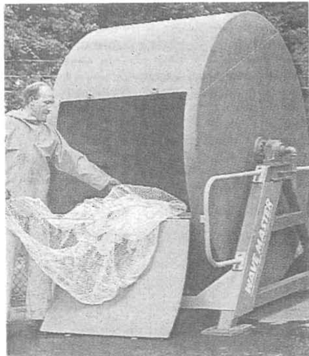
Figure 76 : Machine à laver les filets Wavemaster. Cette machine fonctionne comme une machine à laver le linge.
