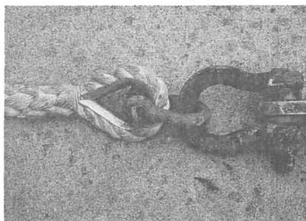
Figure 50 : Montage d'un filin sur une manille. Le filin (à gauche) est équipé d'une cosse coeur épissée. Cliché IFREMER, D. Priour.
