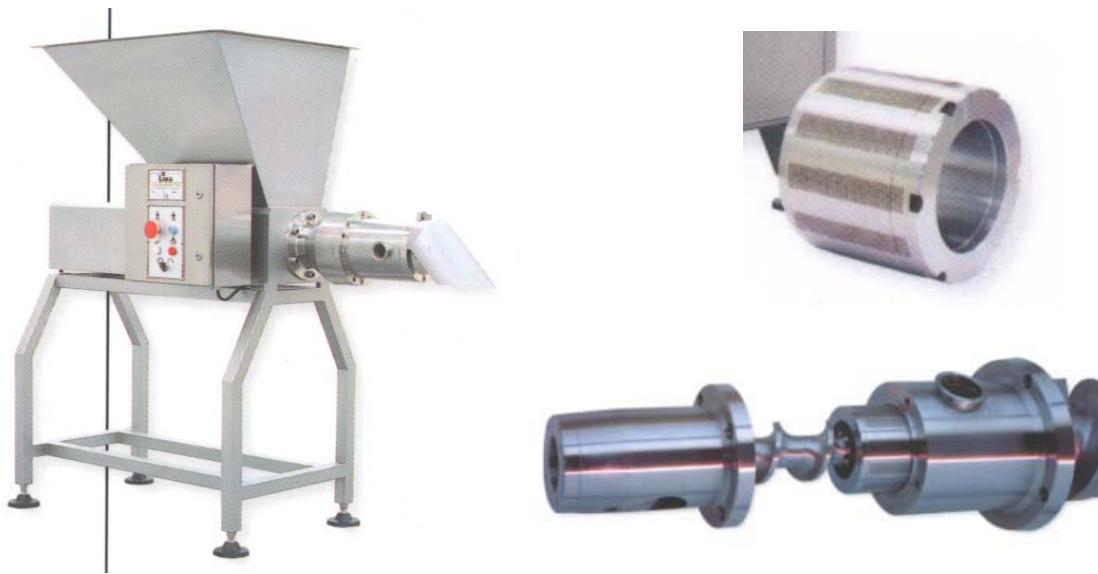
Figure 31 Séparateur mécanique de type Lima ® installé sur la chaîne de transformation en remplacement du séparateur de type Baader ®.
