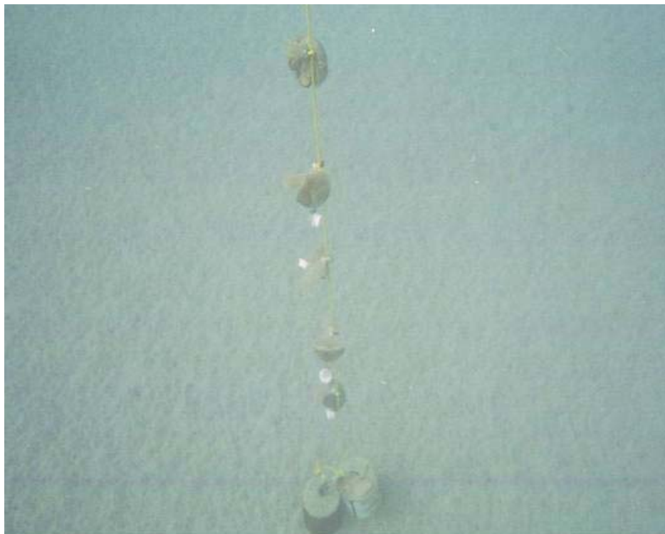
Fig. IV.11 : Les transplants in situ ; on remarque les DGT fixés au même niveau que les filets contenant les éponges
