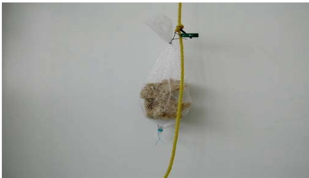
Fig. IV.10 : Filet de suspension numéroté avec possibilité de fixer les DGT en parallèle.
