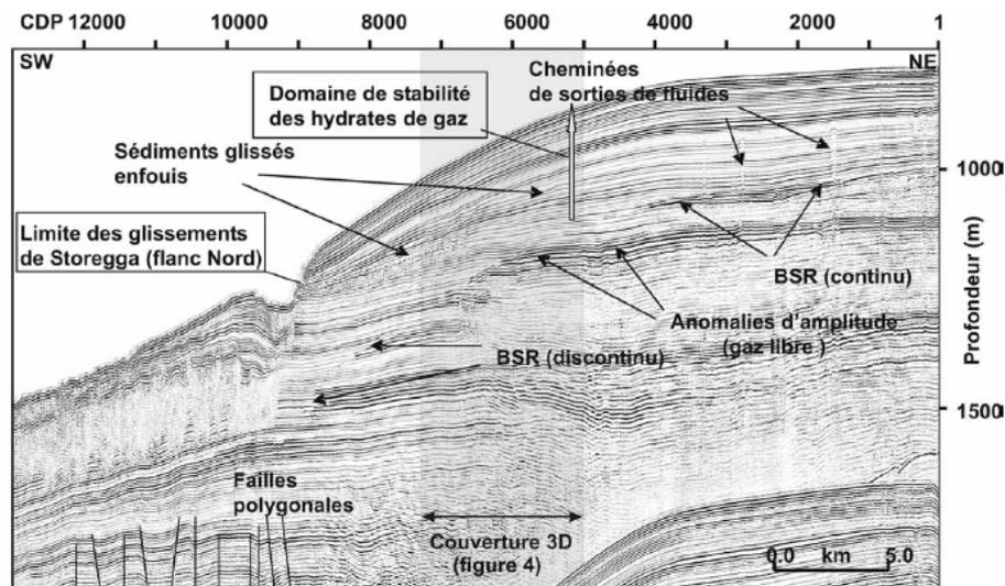
Figure 2 : Profil HTK2D – 05 migré en profondeur. L'axe des abscisses est repéré par le numéro de CDP (Common Depth Point) ou Point Milieu Commun. Noter que le BSR (Bottom Simulating Reflector) est matérialisé par un réflecteur continu au NE et par la terminaison d'anomalies d'amplitudes au SW du CDP 9000. La zone grisée couverte par le bloc sismique 3D est présentée en figure 4.
