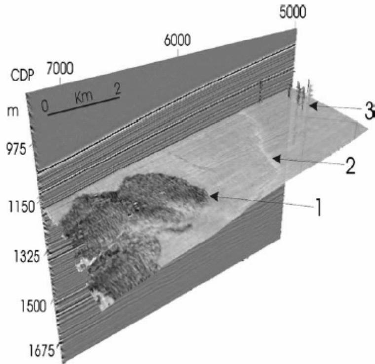
Figure 4 : Image 3D d'un paléo glissement : carte de l'amplitude relative de l'horizon glissé extraite du bloc de données sismiques 3D. 1 = limite haute des sédiments fortement glissés, 2 = limite haute des sédiments peu déplacés, 3 = cheminées de sorties de fluides.
