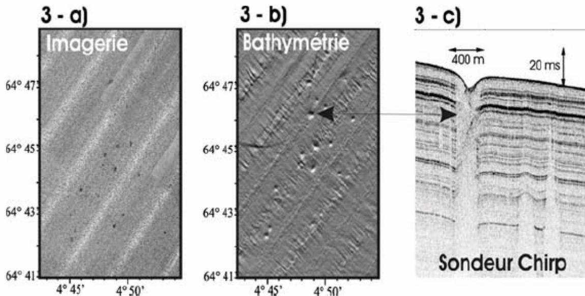
Figure 3 : Expression des sorties de fluides, sur un zoom des cartes de bathymétrie (3-a) et d'imagerie (3-b), et sur un enregistrement du sondeur de sédiments (3-c).
