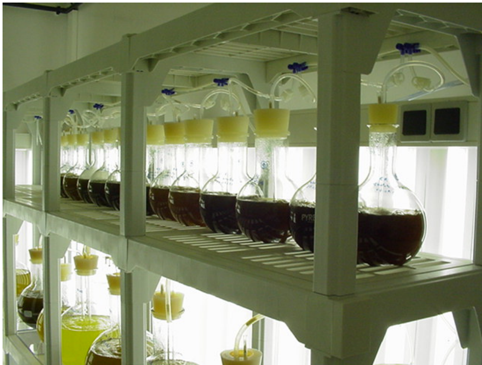
Fig. 1 : Dispositif expérimental pour l'étude de la caractérisation des microalgues fourrage (ballons de 2L, station d'Argenton).
