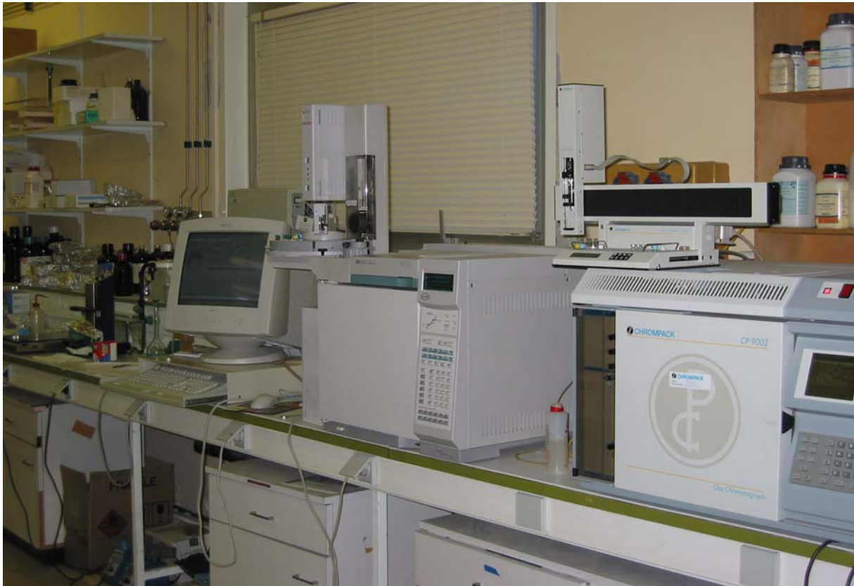
Chromatographes en phase gazeuse (Hewlett-Packard HP 7890 et Chrompack CP9002), Laboratoire Physiologie des Invertébrés de Brest : photo J.R. Le Coz.
