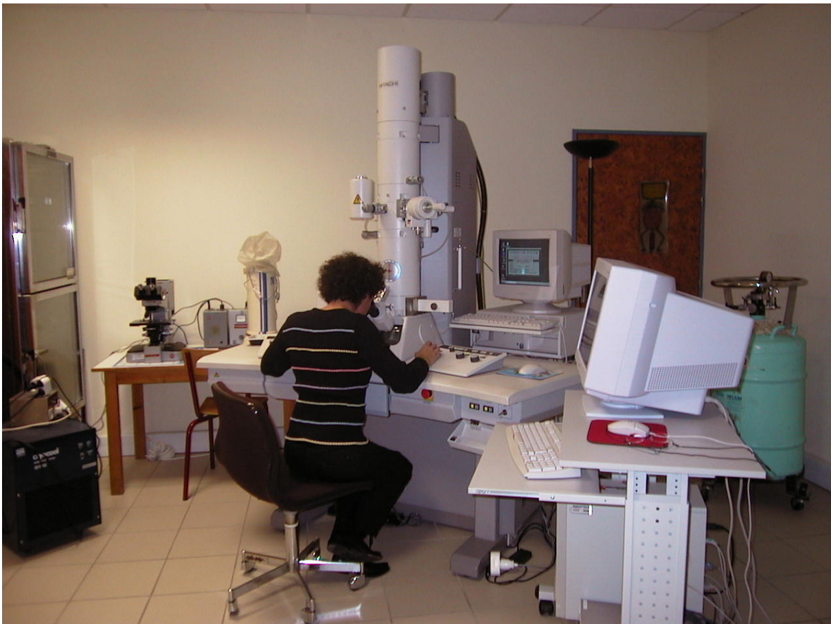
Microscope électronique à transmission (Hitachi H7500), Observatoire Océanologique de Banyuls : photo M.J. Chrétiennot-Dinet.
