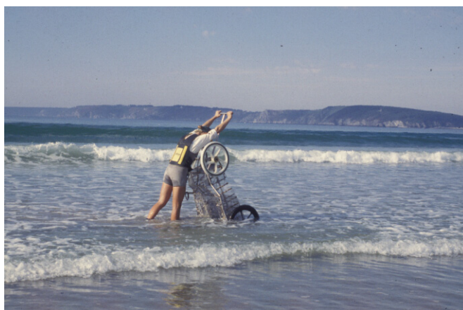
Figure 12 - Mise en œuvre de la drague à telline. Drague en conditions de pêche (à gauche). Le basculement de l'engin de pêche permet de stocker les tellines au fond de drague et d'améliorer ainsi la filtration du sable et de soulager la charge (à droite).
