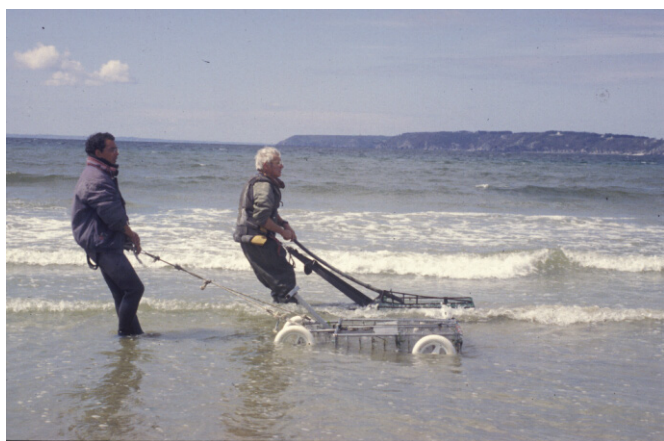
Figure 12 - Mise en œuvre de la drague à telline. Drague en conditions de pêche (à gauche). Le basculement de l'engin de pêche permet de stocker les tellines au fond de drague et d'améliorer ainsi la filtration du sable et de soulager la charge (à droite).
