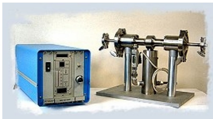
Figure 6 : Process Sonitube proposé par Sodeva : Le produit contenu dans un réservoir approprié circule en boucle. Le réservoir peut être à double enveloppe avec circulation d'un liquide de refroidissement, pour maintenir le produit dans une fourchette de température précise, si nécessaire. Ce process peut permettre le traitement d'une centaine de litres de produit.
