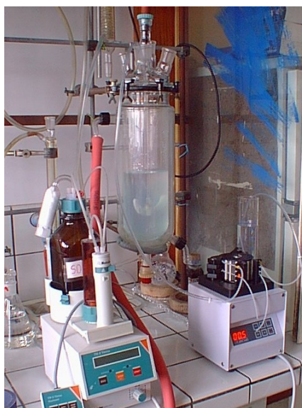
Figure 23 : Montage utilisé lors d'un premier transfert du protocole de dépolymérisation par catalyse métallique sur 2g d'EPS.
