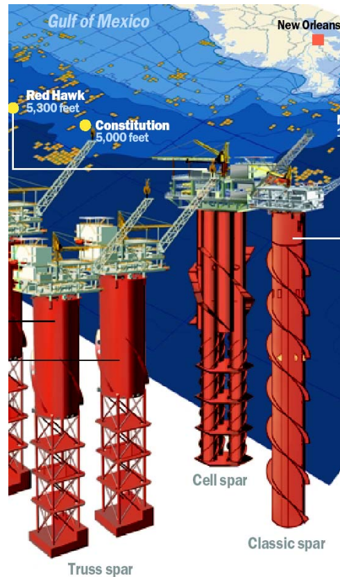
Figure 1.3. Spar 'Red Hawk', dans le Golfe du Mexique. 6 lignes tendues en polyester de 1200 tonnes force à la rupture tiennent le spar.
