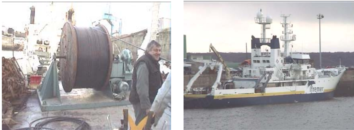
Figure 1.2. Câble aramide de manutention à bord navire d'IFREMER (Suroît), force à la rupture de 20 tonnes, 6 km de long.
