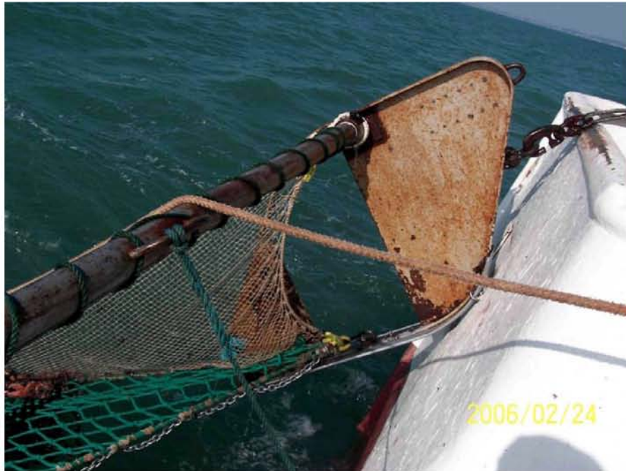
Figure 6 - Chalut String , avec patins de 1 m et ventre en grand maillage
