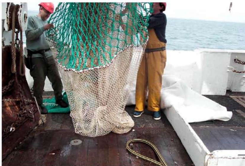
Figure 11 - Face inférieure du chalut à panneaux de 25 m équipé d'une grille à grandes mailles (Photo Y. Désaunay).
