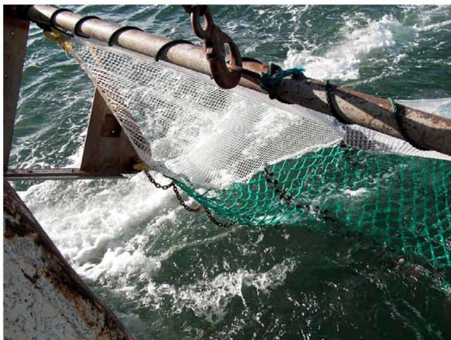
Figure 7 - Chalut String , ventre en grand maillage (100 mm de côté)
