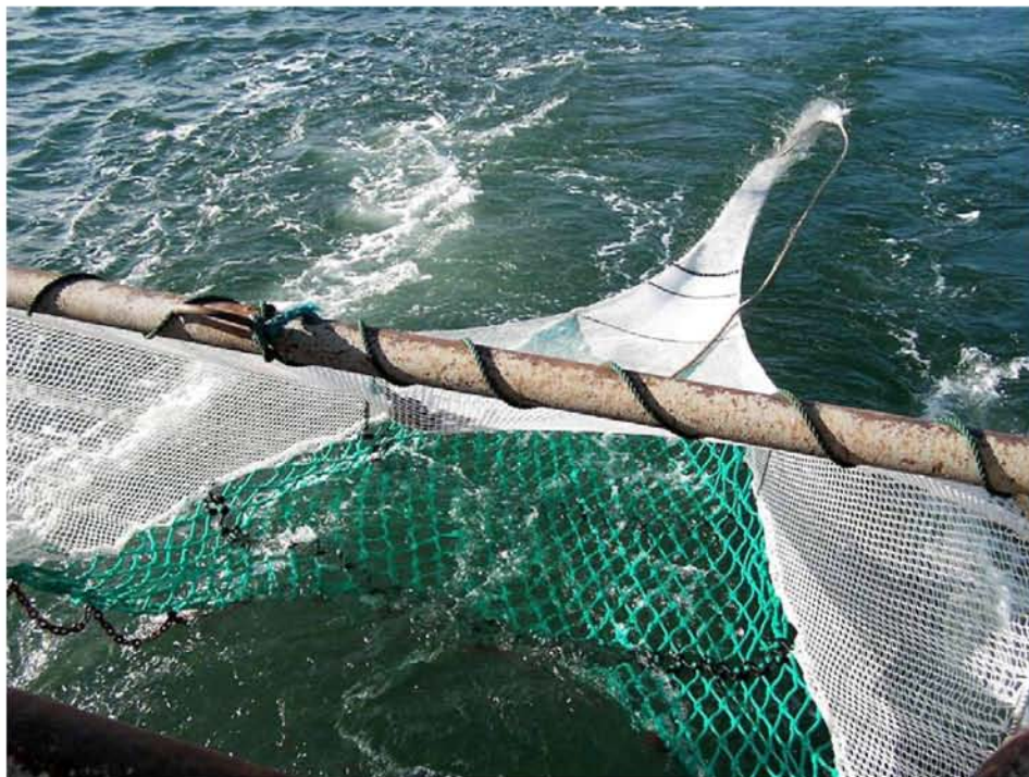
Figure 8 -Nouveau chalut à perche de 3 m (type String) adapté pour les échantillonnages en fonds encombrés. (Photo Y. Désaunay).
