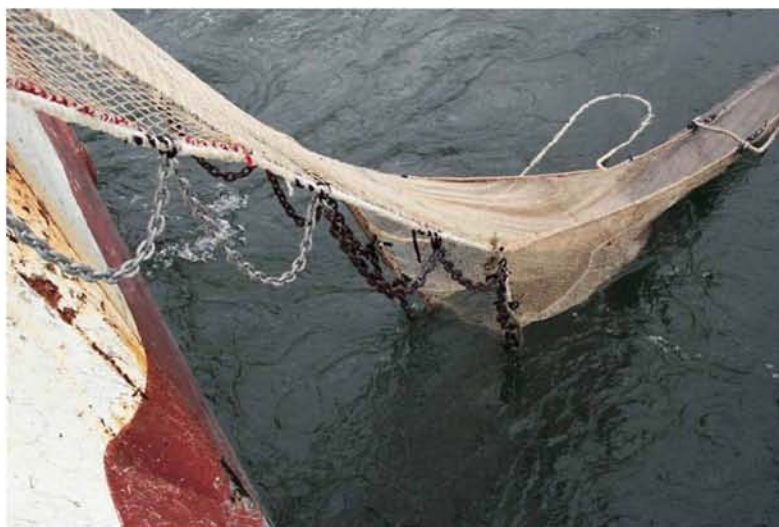
Figure 7- Chalut à perche de 3 m gréé sans ventre. Photo Y. Désaunay.
