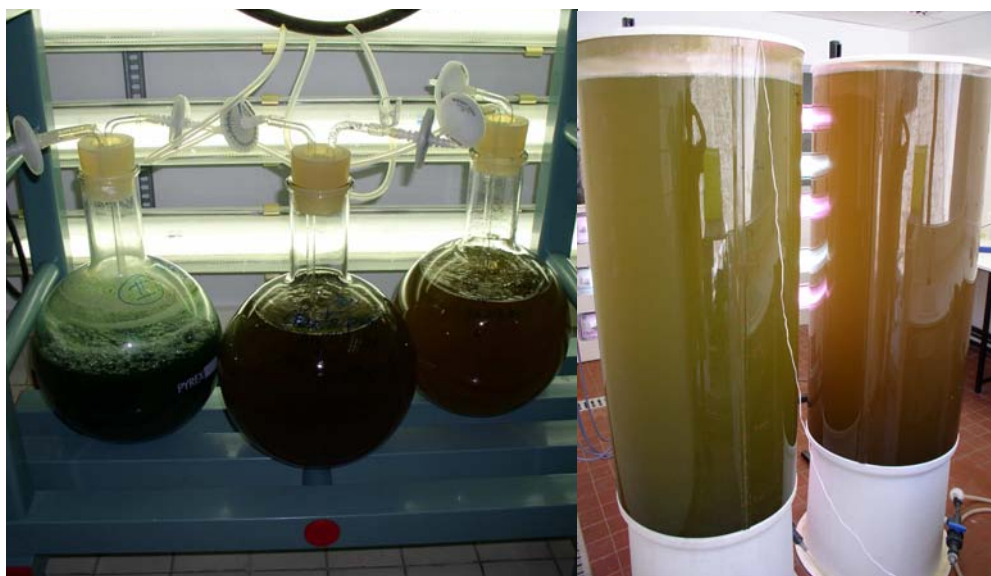
Figure 36 : Culture des microalgues en condition batch, avec éclairage artificiel et bullage constant (à gauche en ballon de 10 l, à droite en scobalite de 300 l). Chaque culture est monospécifique. Cette production a été réalisée au sein de l'IFREMER de Nantes en collaboration avec le laboratoire de Physiologie et Biotechnologie des Algues.
