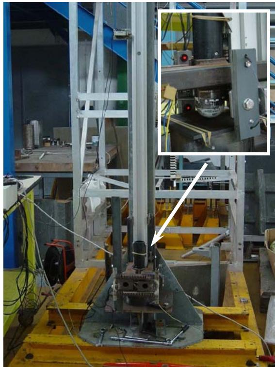
FIG. 6.5 – Montage de l'essai d'impact.
