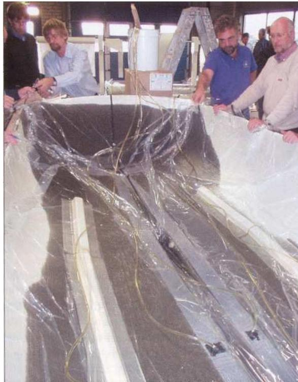
FIG. 1.6 – Procédé de transformation en moule fermé - Infusion.
