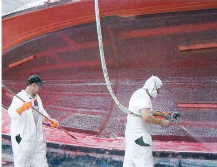
FIG. 1.4 – Projection simultanée.
