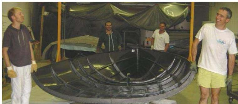
FIG. 8.1 – Détail de la structure d'une coque de bateau de plaisance réalisée en composite monolithique.
